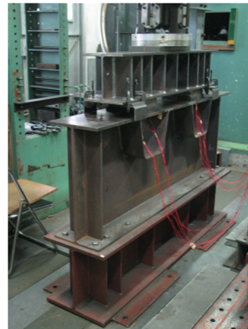
写真-3 交差部疲労試験状況
