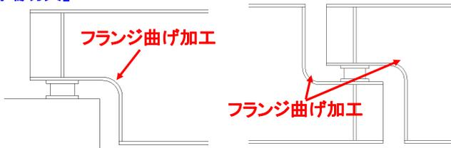
図-2.12 フランジ曲げ構造
