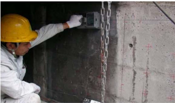
写真-4.3 電磁レーダによる鉄筋探査
