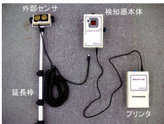
写真-5 弾性スイープ波法の調査機材
