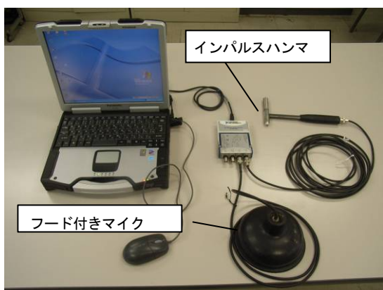
写真-3 打音法の調査機材
