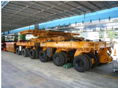
写真-12 移動多軸台車(ターンテーブル)
