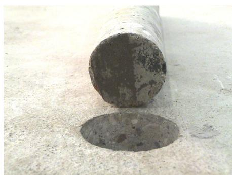
写真-9 コンクリートコア削孔試験の例
