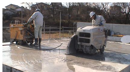
(e) 試験体の切断
