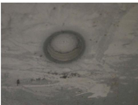
写真-10 底鋼板コア削孔試験の例
