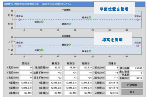
図3 送出し位置計測システムの概要
