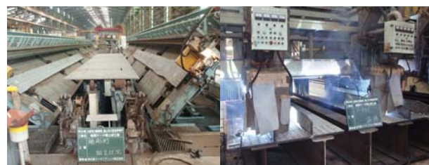
写真-2 FA溶接機の適用
