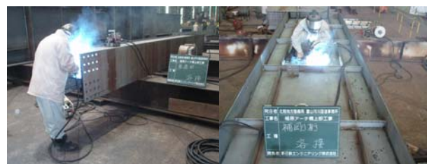
写真-3 簡易自動溶接機の適用
