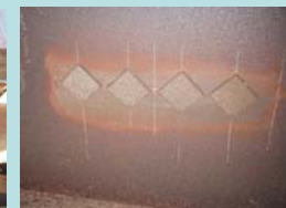
既設橋梁型ワッペン試験の例
