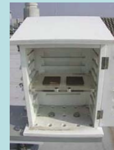
小型百葉箱のワッペン試験の例
