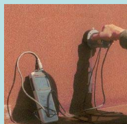
付着塩分計測 (伝導度法)
