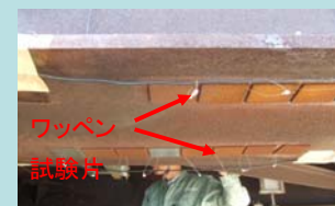
既設橋梁型ワッペン試験の例
