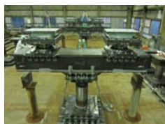
橋脚・支承・ 6分力計の設置
