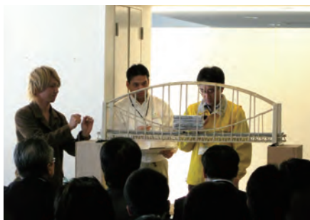
近畿地区プレゼンテーション（移動荷重による載荷試験）
