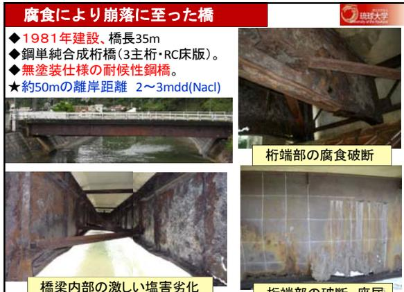
桁端部の腐食破断
