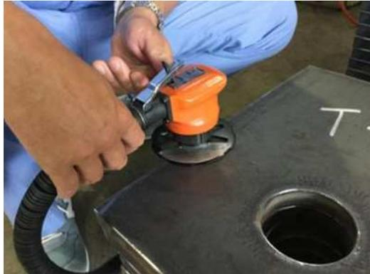
写真-3.3 曲面加工用工具
