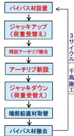
図-5.14 部分取替施工フロー
