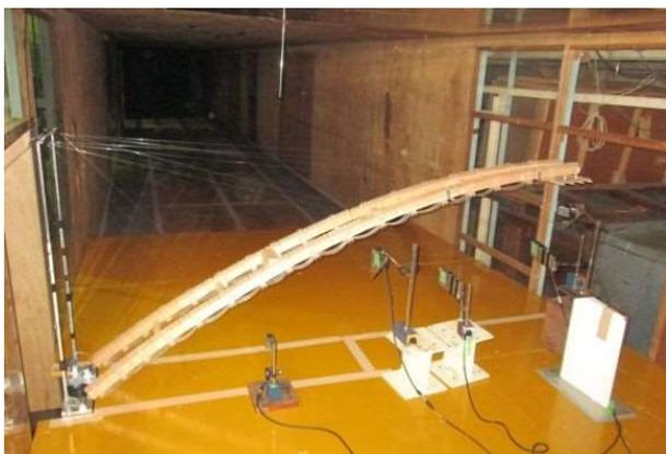
写真12 風洞試験状況
