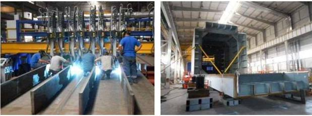
写真-8 主塔パネル製作(左:リブ溶接, 右:組立)
