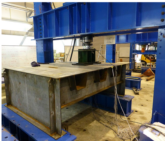
図-42 疲労試験の状況
