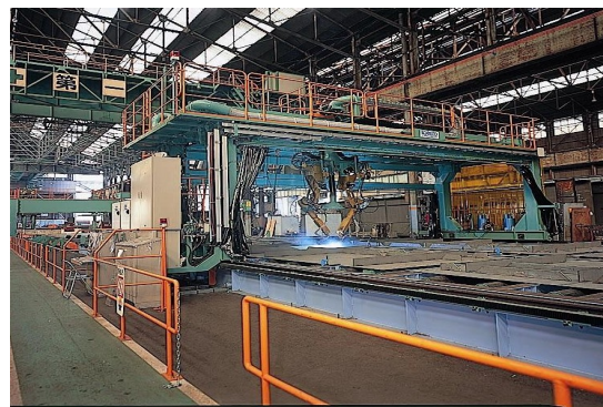
写真-22 多関節溶接ロボット
