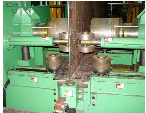
写真-12 I形組立装置(ローラー部)
