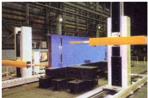
写真-26 3次元視覚センサーによる計測
