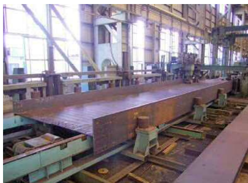
写真-11 I形組立装置(全景)
