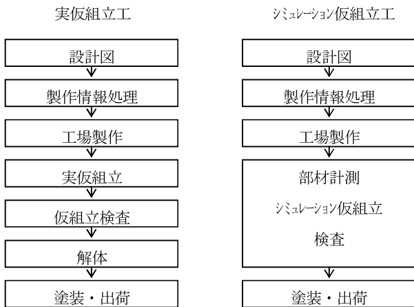
図-4 仮組立工法別による工程比較
