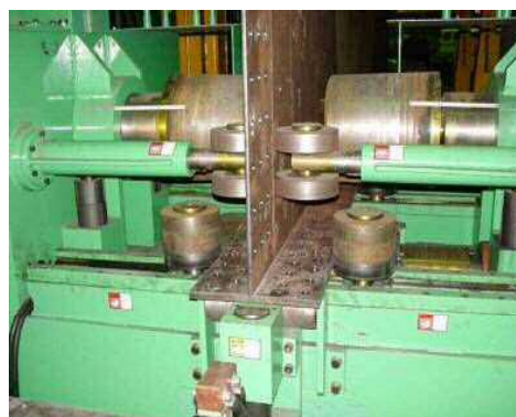
写真-12 I形組立装置(ローラ一部)
