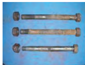
写真-53 引張試験後のφ45(左:健全なボルト 右:腐食ボルト)
