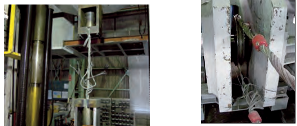
写真-41 1本引き試験 写真-42 2本引き試験
