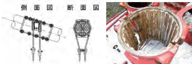
図-12 ケーブルバンド構造
