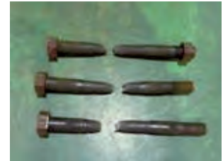
写真-53 引張試験後のφ45(左:健全なボルト 右:腐食ボルト)
