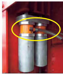
写真-44 新設ロードセル
