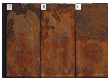
写真-8 無塗装試験体 No. 8 の外観（160 サイクル）
