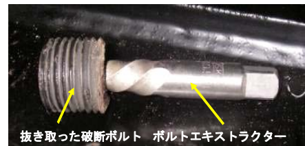
図-10 ボルトエキストラクター
