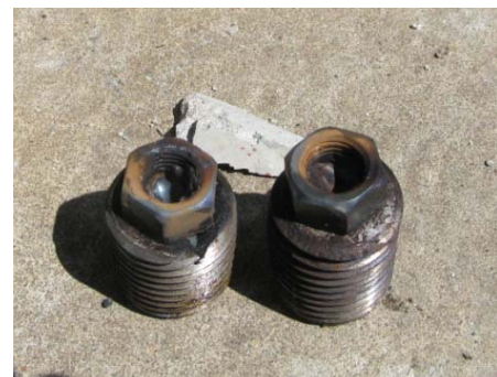
写真-15 ナット溶接
