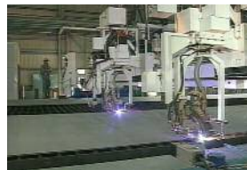
NCプラズマ切断機
