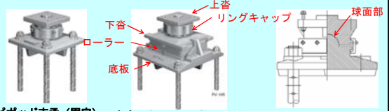
ピボット支承 (固定) ピボットローラー支承 (可動)
