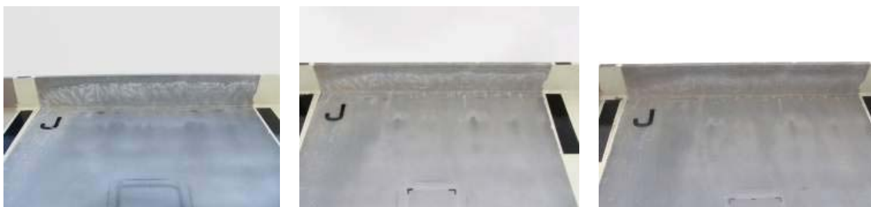
写真－5 仕様J（亜鉛・アルミニウム合金：JIS 溶射）
