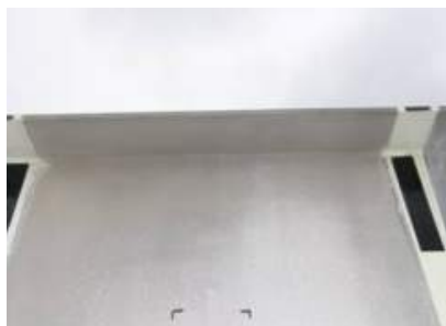
写真-4 仕様I（アルミニウム：JIS 溶射）
