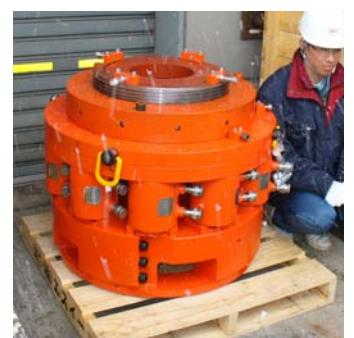
写真-2 マルチストランド ジャッキ
