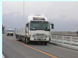
荷重車載荷試験
