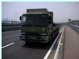
荷重車載荷試験
