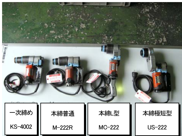
写真-28 トルシアボルト用レンチ (右端は狭隘部用レンチ)
