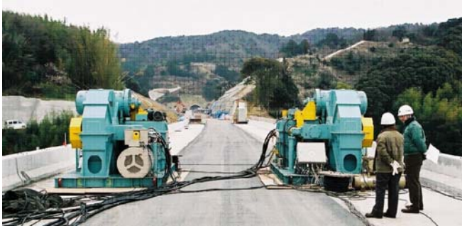
写真-1 起振機（土木研究所所有）による実橋振動試験
