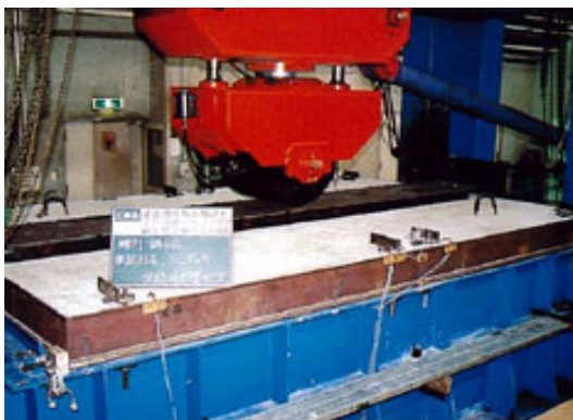
写真-3 土木研究所における輪荷重走行試験 (1997年～)
